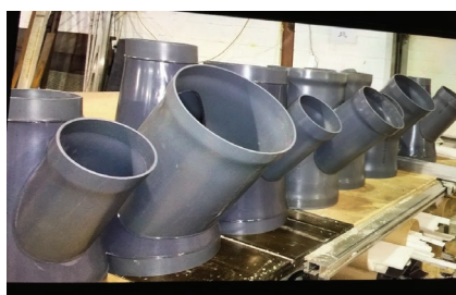
Fabrication de raccords en PVC pour des réseaux de ventilation de tout diamètre
