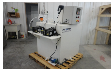
Fabrication d'un système de neutralisation des eaux sur mesure avec pompes doseuses, contrôleur et agitateur mécanique
