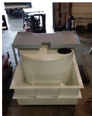
Fabrication d'un réservoir de rétention sur mesure avec structure en acier pour accueillir un réservoir d'alimentation de produits chimiques
