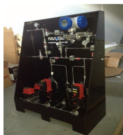
Fabrication de support en copolymère pour système de pompes doseuses
